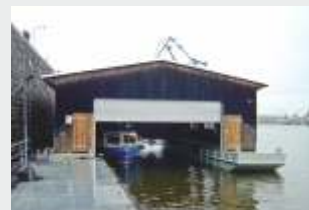
M9S Industrie-Rolltor als Abschluss für ein Bootshaus (Sonder-Anwendung)
