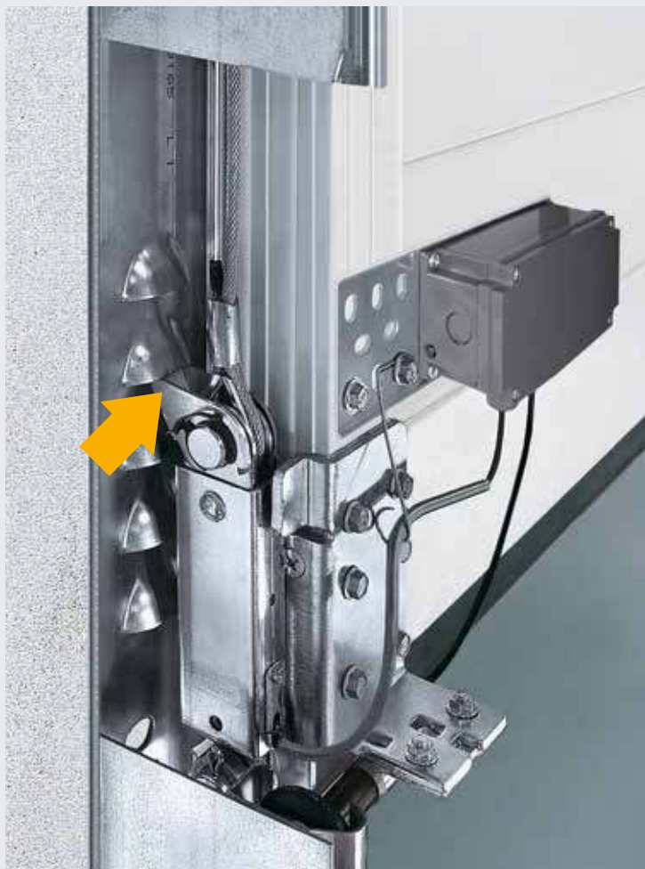
Der Verriegelungshaken der Aufschiebesicherung rastet beim Hochhebeln des Tores automatisch fest ein.
